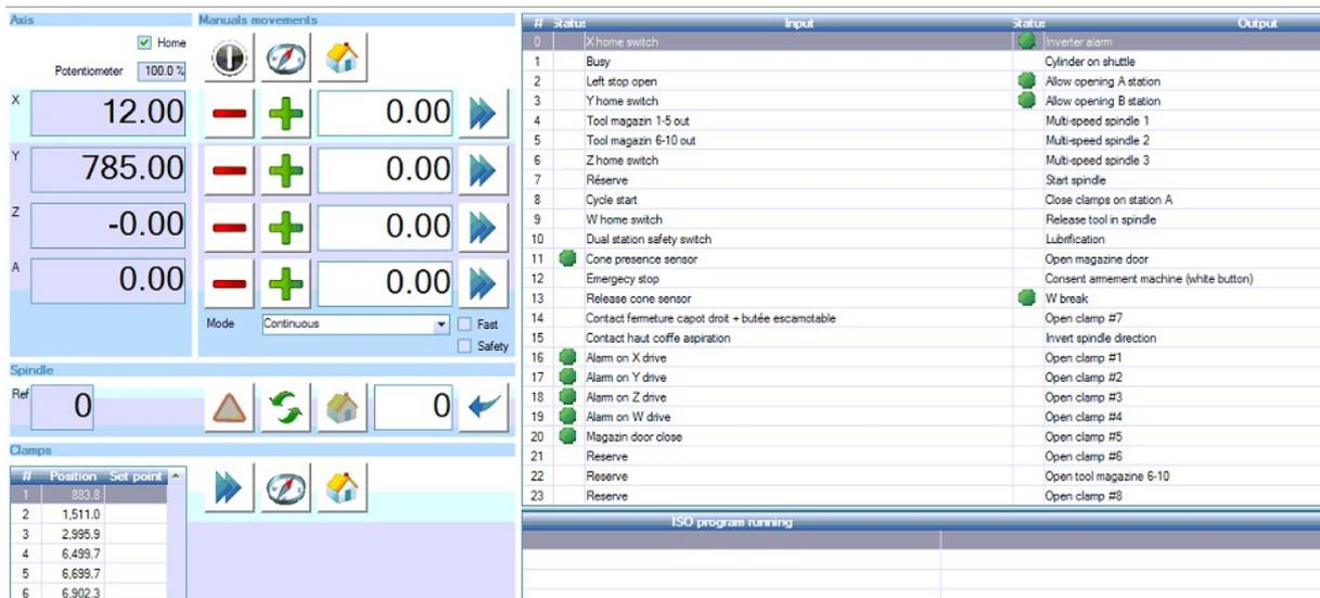
Le cadre « Axe » donne l'état de l'indicateur POM (une coche indique que la prise d'origine a été effectuée), du potentiomètre d'avance, et la position courante des 4 axes de la machine.
