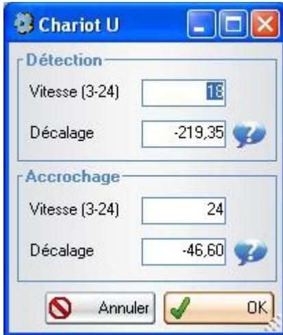
Le cadre « détection » permet de régler le cycle de relevage des positions d'étaux. Plus la vitesse sera rapide, moins précise sera la détection. Le système mécanique de prise des étaux autorise une erreur de quelques millimètres (rayon du cône de centrage sur l'index de positionnement).
