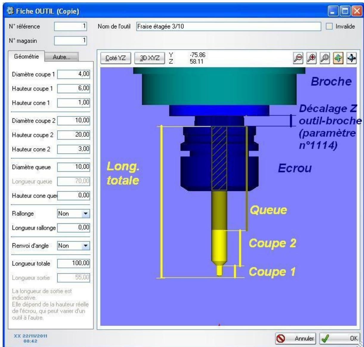
L'outil est modélisée par 2 zones de coupe et une queue. Chaque zone est constituée d'une partie conique et d'une partie cylindrique. On définit la partie cylindrique par un diamètre et une longueur, et la partie conique par une hauteur.
