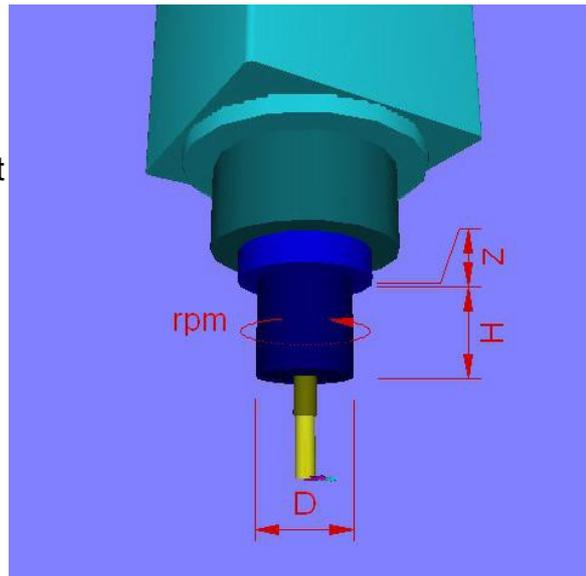
Hauteur H du pivot de la broche. Distance entre le nez de broche et l'axe du pivot. Ce paramètre n'est actif que sur une machine dont la broche s'incline.
