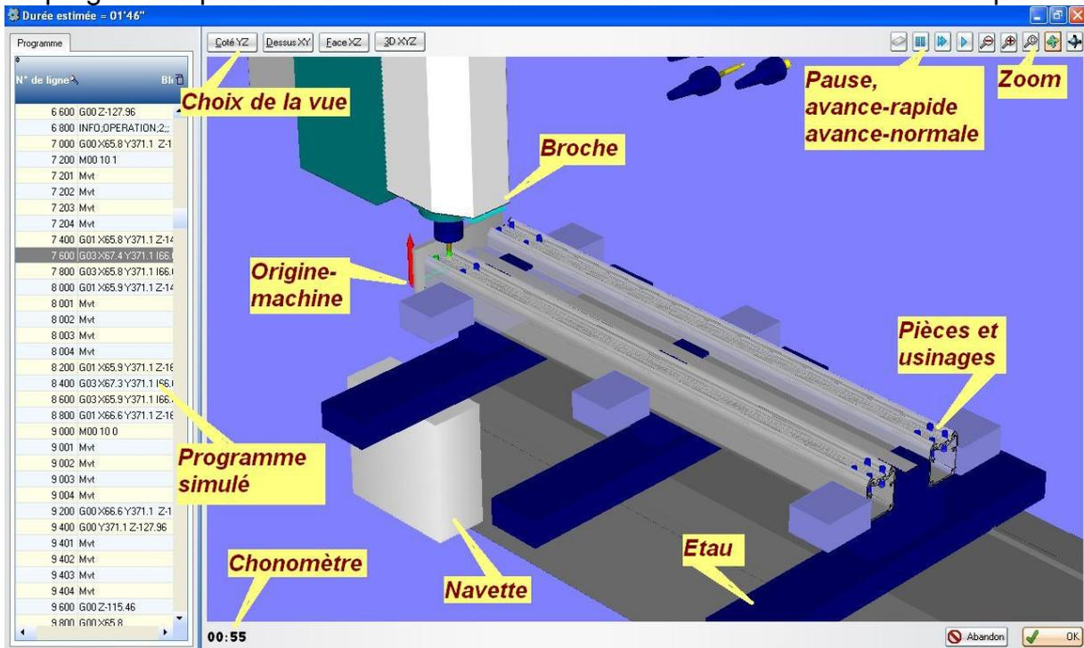
On choisi de simuler ou pas le programme à l'aide du paramètre machine n°105.
