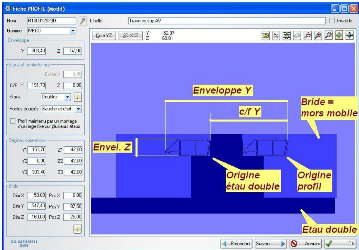
L'option « montage d'usinage » doit être cochée lorsque l'on place la pièce dans un montage, lui même fixé sur les étaux. Dans ce cas, les étaux sont positionnés à la main par l'opérateur, ils ne sont pas déplacés par la navette.
