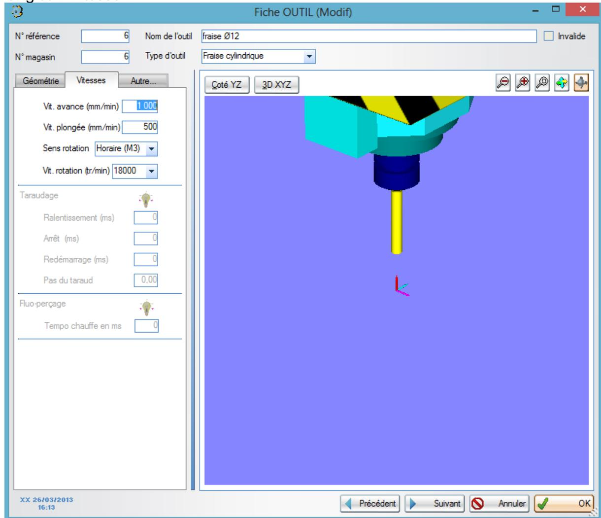
Les vitesses d'avance et de plongée en mm/min sont utilisées par les assistants lors de la création des opérations d'usinage.
