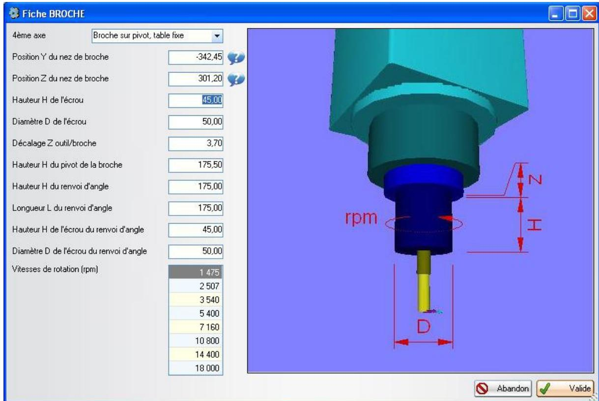
4eme axe: Pour usiner sur le coté d'un profil, on peut basculer la broche (cas du centre Boxer = broche sur pivot, table fixe) ou la pièce (cas du centre Aster = broche fixe, table sur pivot)
