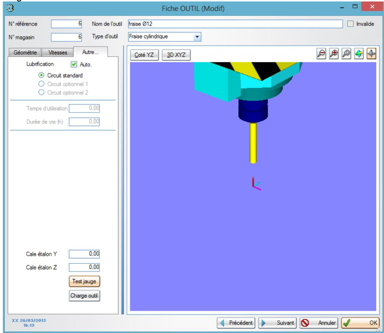
La lubrification peut être déclenchée systématiquement pendant tout le cycle d'usinage ou uniquement sur demande du programmeur.
