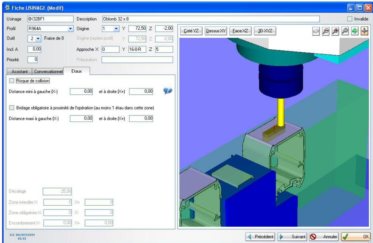
Risque de collision: cette option doit être cochée si il y a un risque de collision entre la broche et les étaux. Dans ce cas il faut spécifier la zone interdite aux étaux.
