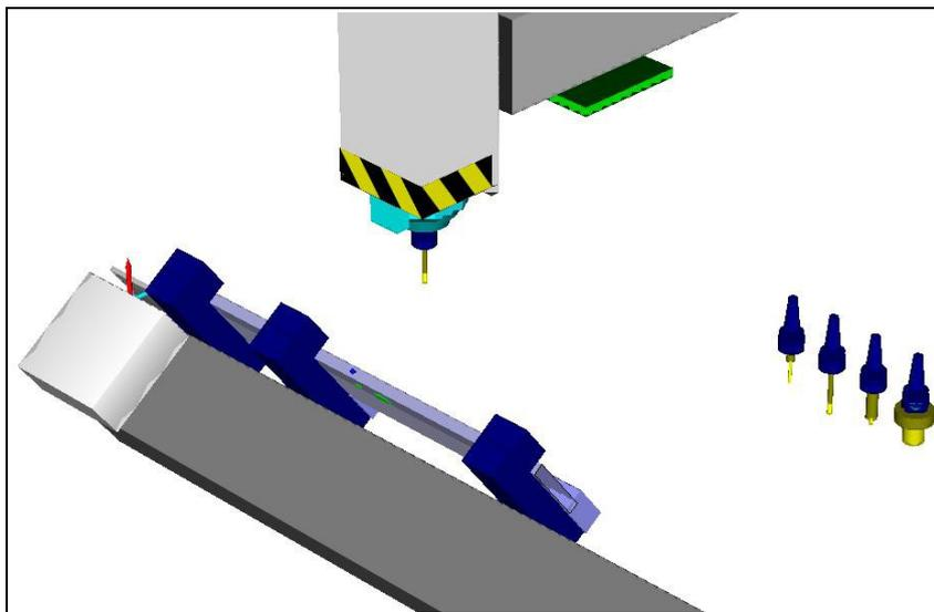
Les centres **PHOENIX** sont des centres monopostes. La broche est portée par un chariot 3 axes XYZ, la pièce est fixée sur une table pivotant autour d'un axe A.
