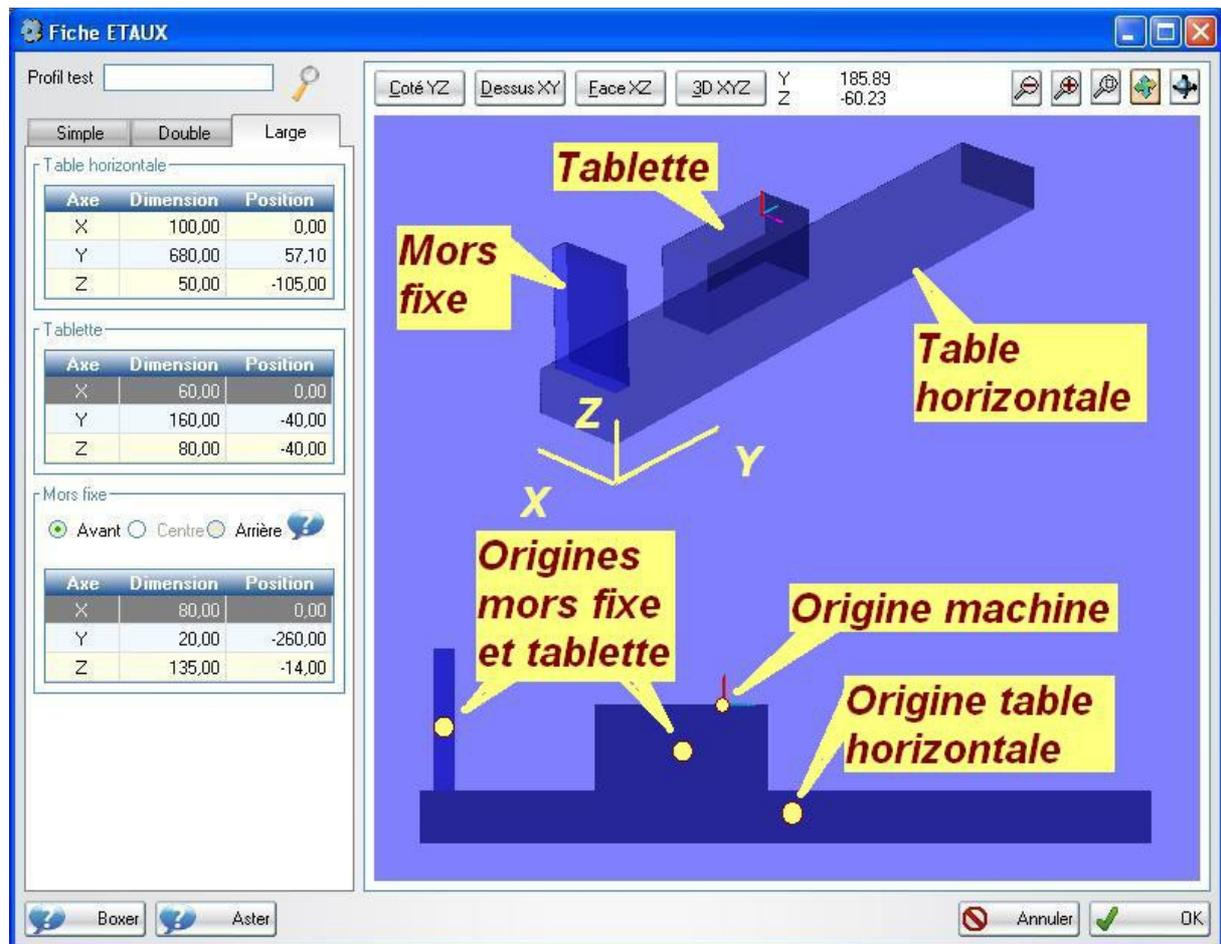
Chaque modèle d'étau est composé d'une table horizontale, d'une tablette et d'un mors fixe. La table horizontale est commune aux 3 variantes. Chaque élément est modélisé par un parallélépipède dont on définit les dimensions et la position du centre.
