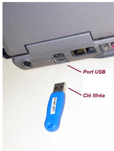
Illustration 8: Branchement de la clé sur le Port USB du PC
