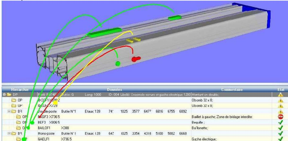
La pièce est réalisée dans un profil R974B de 1m en butée à gauche. La vue a été tournée pour afficher les opérations effectuées sur la face arrière;
